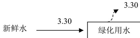
图 2.1-4-2 二、三季度绿化水平衡图单位：m<sup>3</sup>/d
